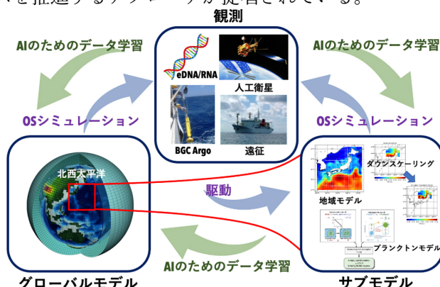
図12.人工知能技術を用いた観測システムと統合された地球システムモデリングの枠組み（Schneider et al.）。観測は、AI技術によってESMとプロセスモデルの性能を向上させるためのデータを提供することができ、それを応用して再びAIで効率的な観測ネットワークを構築することができる。また、高解像度モデルの結果に基づく低解像度グローバルESMで使用されるパラメータ化スキームの開発も促進される。このアプローチにより、幅広い海洋学分野にわたる分析を最適化することができる。
